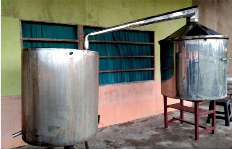
Gambar 3.3. Contoh bentuk alat penyulingan minyak kayu putih
