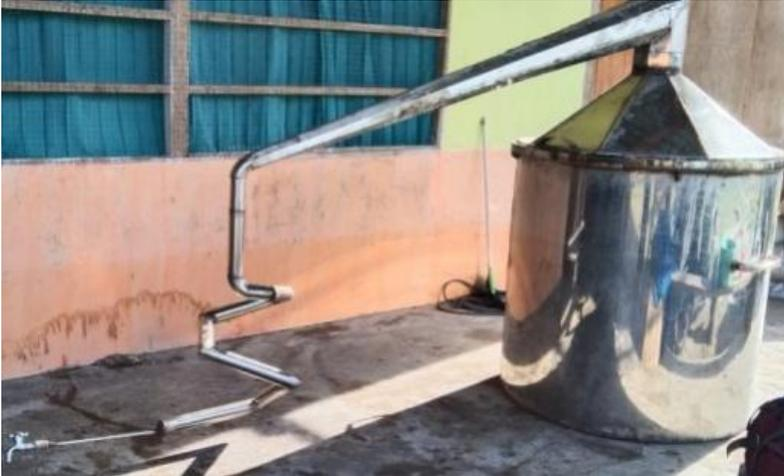
Gambar 3.11. Pipa sirkulasi uap berbahan stainless yang terhubung dengan tangki penyulingan
