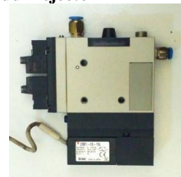
Gambar 15. Vacuum Ejector dengan Valve and Switch SMC ZM131H-K5LZ-E15L-Q
