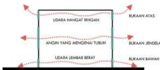
Gambar 4. Skema Bukaan Pada Bangunan
