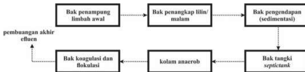
Gambar 1. Skema pengolahan limbah batik
