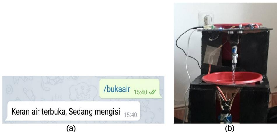
Gambar 6. Pengujian bot telegram mengisi air
