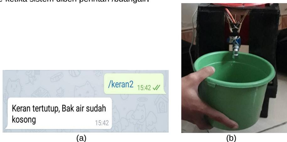
Gambar 9. Pengujian bot telegram menutup keran pembuang air
