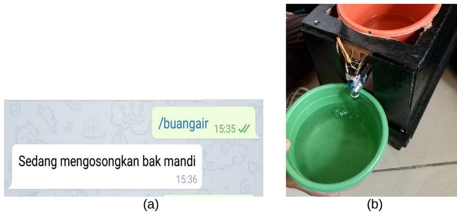
Gambar 8. Pengujian bot telegram membuang air
