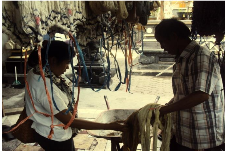
Gambar 2. Proses pencelupan dengan menggunakan zat pewarna dan hasil dari benang-benang yang telah dicelup dan siap untuk ditunen. (foto: Ni Luh W.Sayang Telagawathi)
