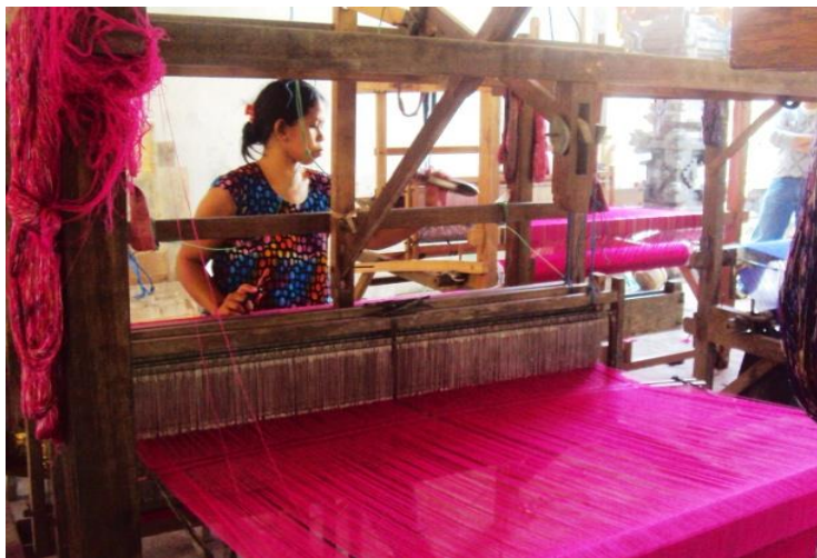
Gambar 1. Benang hasil dari pencelupan dan proses menenun dengan ATBM (Alat Tenun Bukan Mesin). (foto: Ni Luh W.Sayang Telagawathi)
