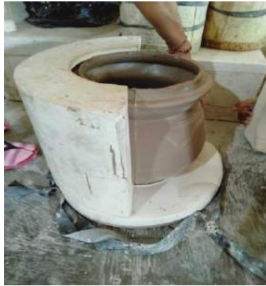
Cara menggunakan cetakan belah
