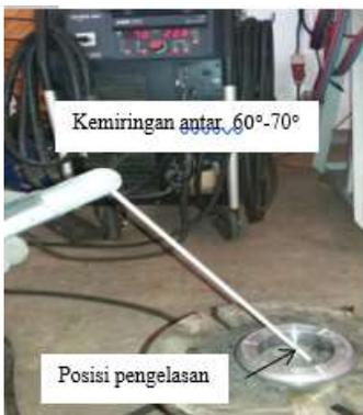
Gambar 1. Posisi Pengelasan dan Kemiringan Elektroda
