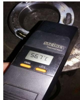
Gambar 3. Temperatur Panas Setelah Pengelasan
