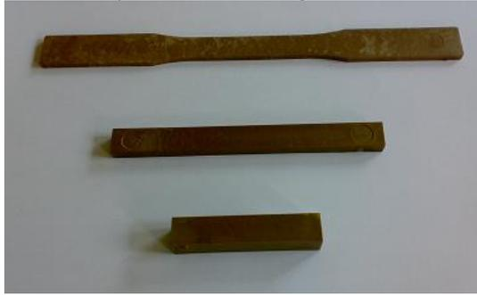
**Gambar 12.** Contoh uji yang dihasilkan dari mesin *injection molding*
