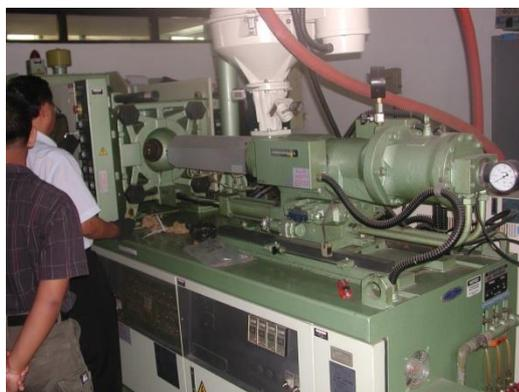
**Gambar 11.** Mesin *injections molding* untuk membuat contoh uji
