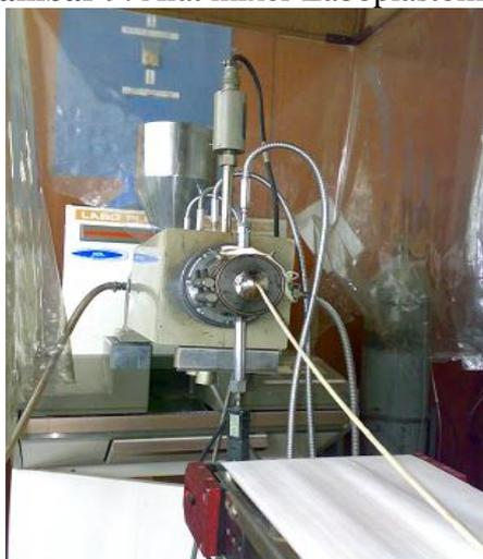
**Gambar 10.** Alat *pelletizer* untuk membuat pelet
