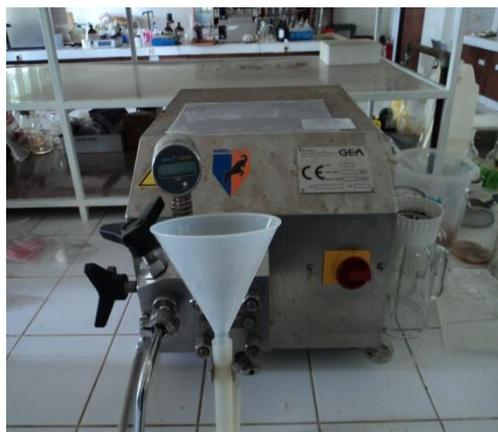
**Gambar 2.** Homogenizer untuk membuat MFC
