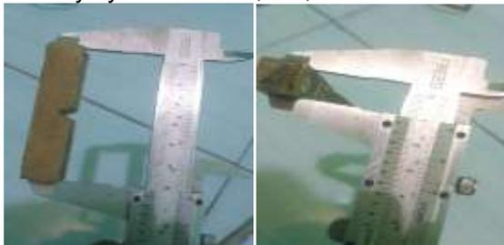
Gambar 2. Pengukuran panjang dan penampang spesimen
