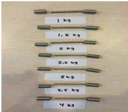
**Gambar 5.** Foto Patahan spesimen material stainless steel 304 dengan beban berbeda-beda
