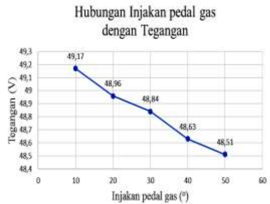
Gambar 15. Hubungan Injakan Pedal Gas (°) dengan Tegangan (V)
