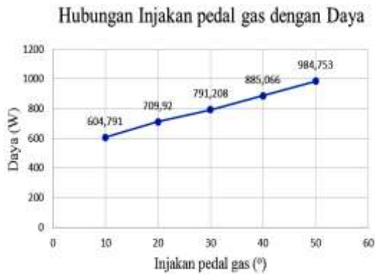
Gambar 17. Hubungan Injakan Pedal Gas (°) Dengan Daya
