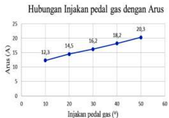
Gambar 16. Hubungan Injakan Pedal Gas (°) dengan Arus (A)
