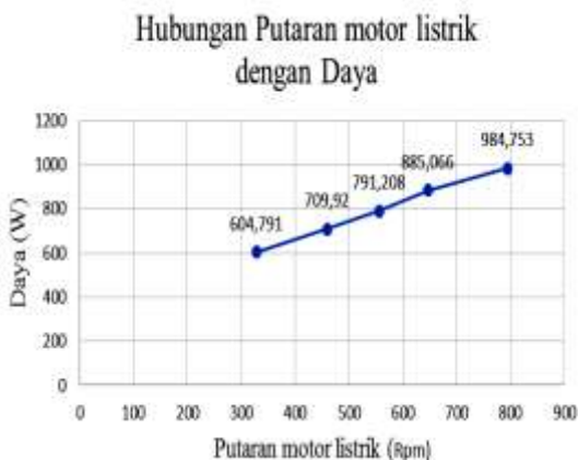
Gambar 18. Hubungan Putaran Motor Listrik (rpm) dengan Daya (W)
