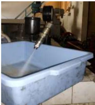
Gambar 4. Pengujian Tekanan Penginjeksian dengan Alat *Nozzle Tester*
