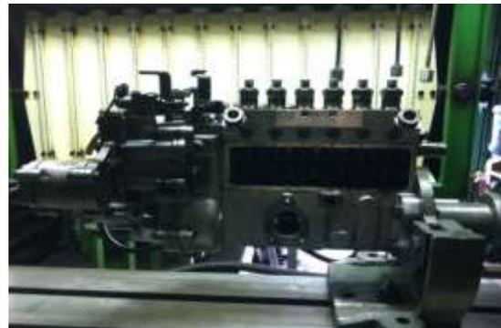
Gambar 3. Pemasangan Pompa Injeksi *Inline* Pada Alat Kalibrasi
