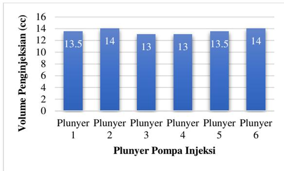
Gambar 6. Volume Penginjeksian Pada Pengujian 1100 rpm Setelah Dilakukan Kalibrasi
