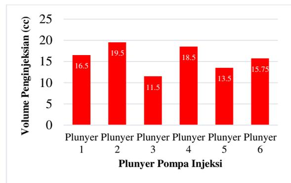
Gambar 5. Volume Penginjeksian Pada Pengujian 1100 rpm Sebelum Dilakukan Kalibrasi
