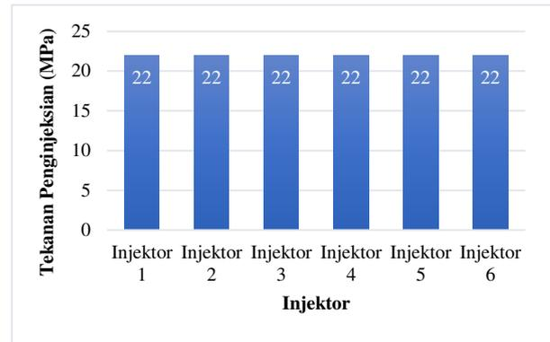
Gambar 8. Tekanan Penginjeksian Setelah Dilakukan Kalibrasi
