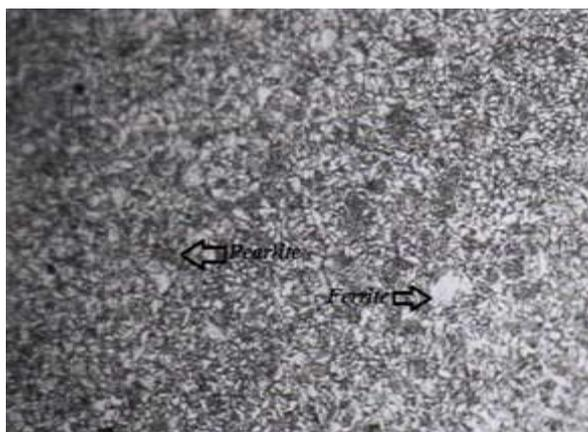
Gambar 18. Struktur mikro pada bagian weld metal SMAW
