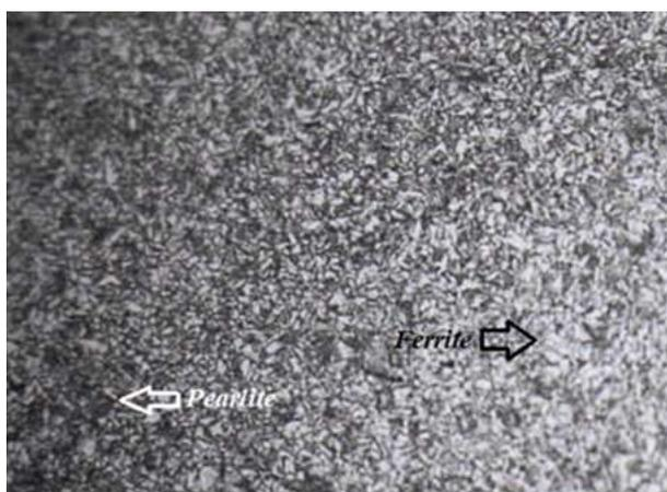
Gambar 17. Struktur mikro pada bagian weld metal GTAW
