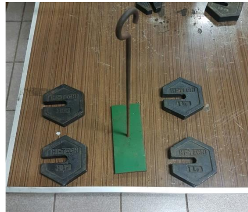
Gambar 7. Perangkat beban pengujian eksperimental fotoelastisitas.
