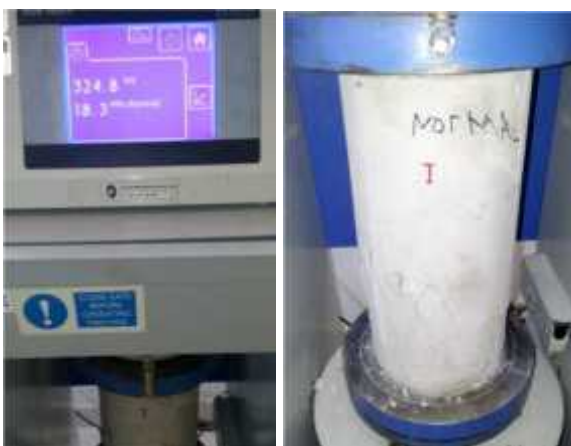
Gambar 2 Pengujian kuat tekan beton
