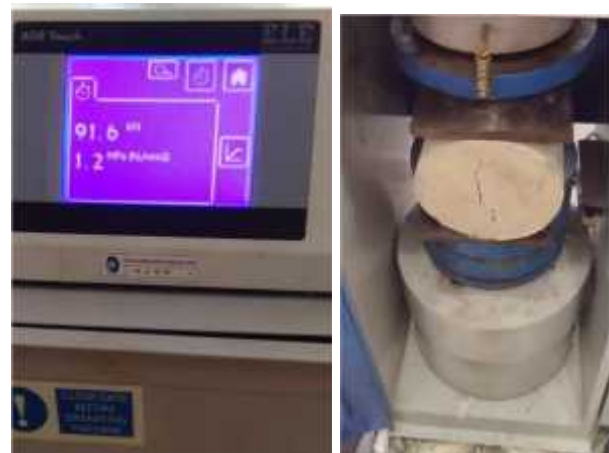
Gambar 3 Pengujian kuat tarik belah beton
