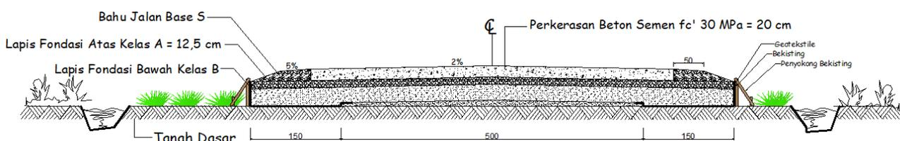
Gambar 7 Potongan melintang desain pada eksisting timbunan base
