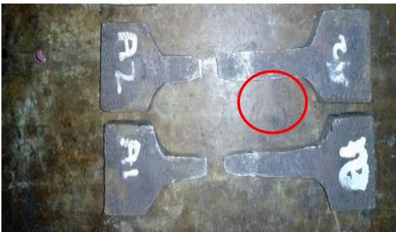
Gambar 13. Spesimen Patah Setelah di Uji Pada Gambar 13 kode A1 dengan lingkaran merah merupakan hasil spesimen yang patah setelah di uji tarik menggunakan material elektroda LB-52.
