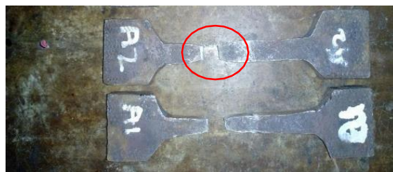
Gambar 8. Spesimen Yang Patah Setelah di Uji
