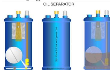
Gambar 4. Laluan Minyak Lumas di *Oil Separator*
