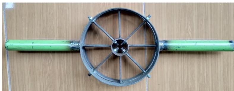
Gambar 4. Tampak atas Prototipe Alat Pemecah Bambu
