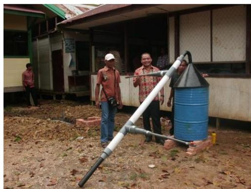
Gambar 4. Reaktor pirolisis sederhana
