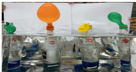
**Gambar 1.** Hasil Reaksi Logam dengan Cairan Pembersih Lantai WPC
