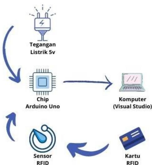
Gambar 3. Diagram Blok Kontrol Sistem Presensi RFID
