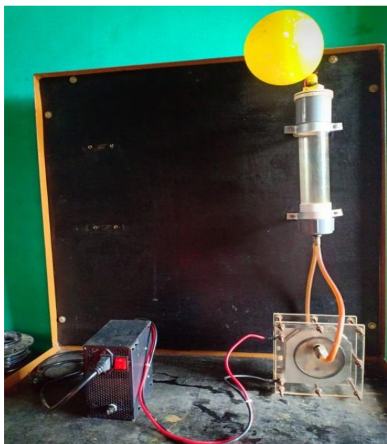
Gambar 3. Instalasi alat uji generator gas HHO
