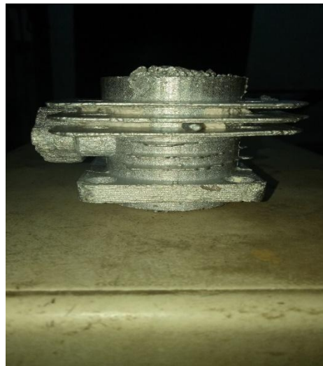
Gambar 3. Hasil Akhir Pengecoran Blok Mesin
