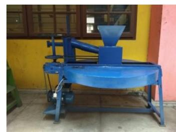
Gambar 2. Mesin Pengupas Buah Kentang Menggunakan Piring Rotari Horizontal
