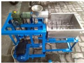
Gambar 9. Perakitan Reduser, Puli, Kopling, Mesin Penggiling dengan Kerangka Mesin
