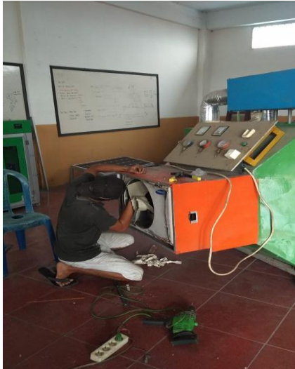
Gambar 1. Memasang kipas dan menyetel kipas
