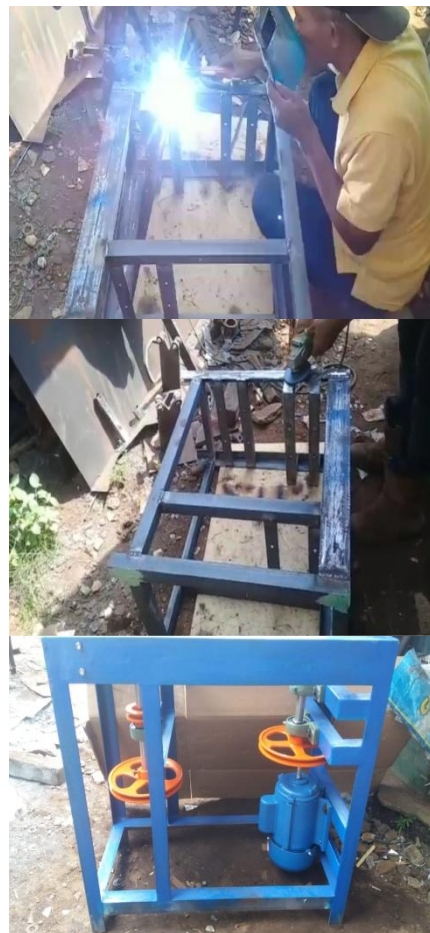
Gambar 5. proses pembuatan mesin perajang singkong
