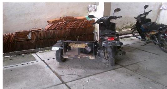
Gambar 1. Rancangan Sepeda Motor Roda Tiga yang biasa digunakan untuk Difabel [3]
