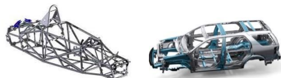
Gambar 1. Tubular Space Frame dan Monocoque
