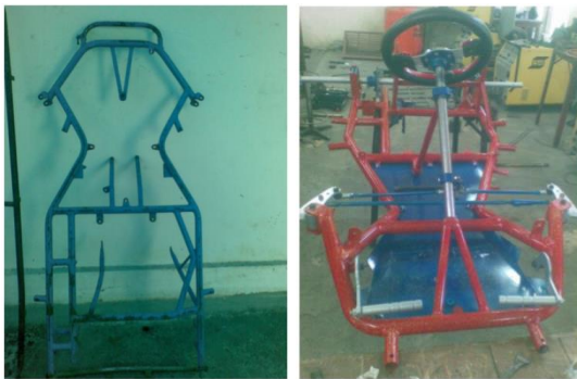
Gambar 6. Hasil Cat Dasar dan Cat Diwarnai Clear Rangka Sasis
