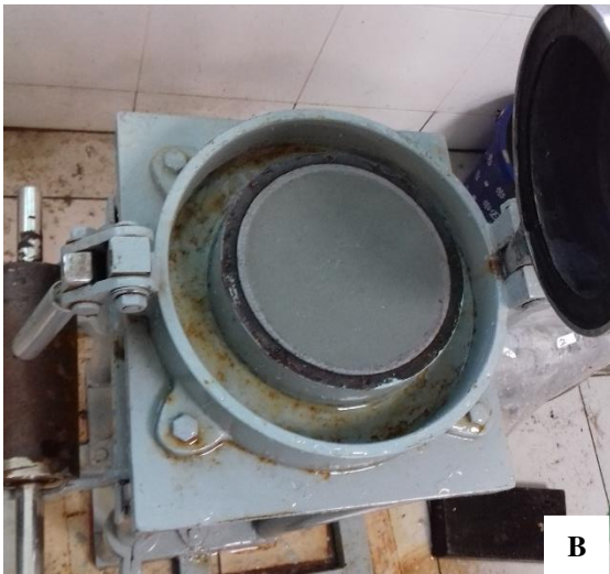
Gambar 5 Teknologi mesin produksi material filter udara sesuai standar TAPPI: (A) mesin beater (B) mesin handsheet .
