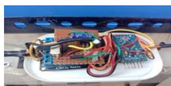
Gambar 2. Rangkaian alat keran air wudhu otomatis
