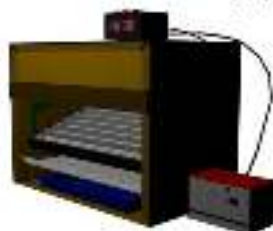
Gambar 3 Rancangan mekanik penetas telur
