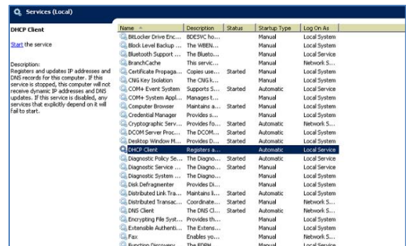
Gambar 4.9 Service DHCP Client dalam kondisi down
