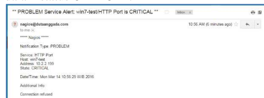
Gambar 4.8 Notifikasi HTTP Port dalam status CRITICAL
