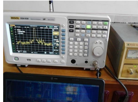
Gambar 11. Pengukuran Transmit pada Frekuensi 7,035 MHz
