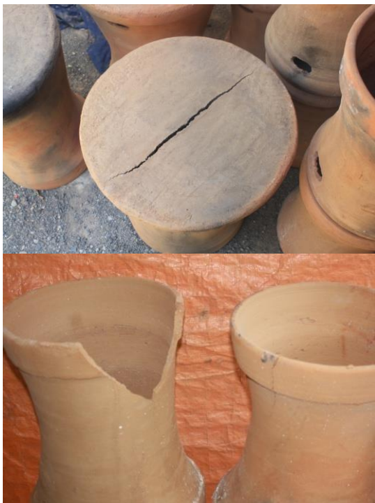
Gambar 1. Salah satu produk kursi keramik yang telah dibakar dan mengalami keretakan yang sangat lebar sebab mutu bahan yang tidak diolah dengan baik.
