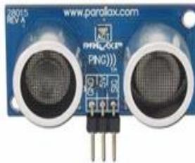
Gambar 3. Modul Sensor *Ultrasonic* (Lingga, 2006:23)
