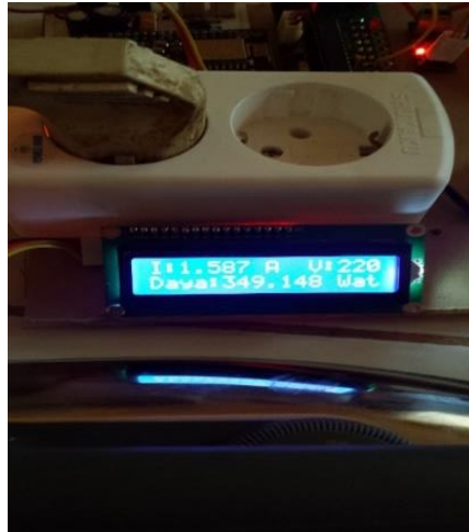
Gambar 10 Pengkondisian ON Terhadap Beban Resistif Setrika listrik
