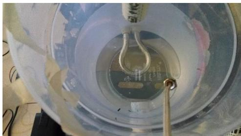
Gambar 7. Penempatan Sensor Termokopel
