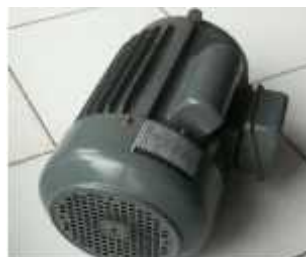
Gambar 2.6. Bentuk Fisik Motor Kapasitor
