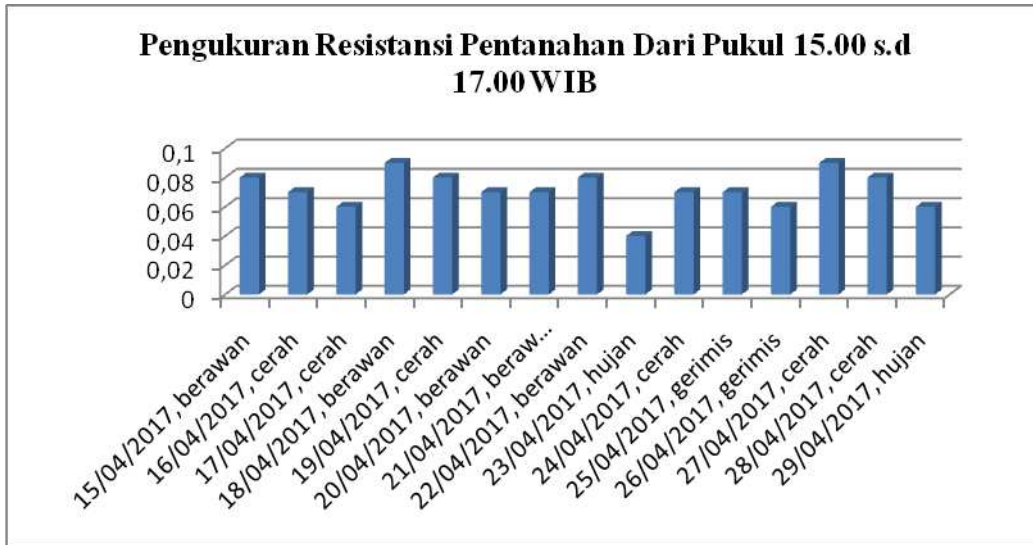
Gambar 4.2 Grafik Hasil Pungukuran Resistansi Pentanahan Pada Sore Hari
