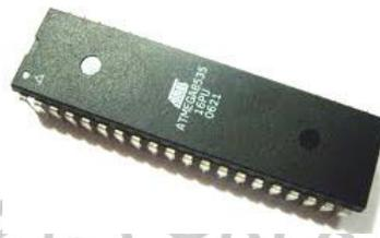
Gambar 1 Mikrokontroler ATmega8535
