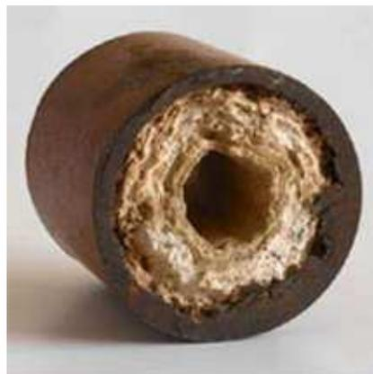
Gambar 1. Kerak yang di akibatkan Kalsium Karbonat (Luminoruv,2012)
