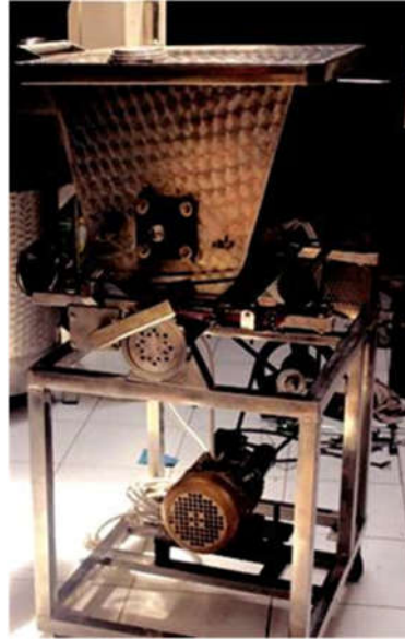
Gambar 8. Mesin aduk yang sudah dirakit
