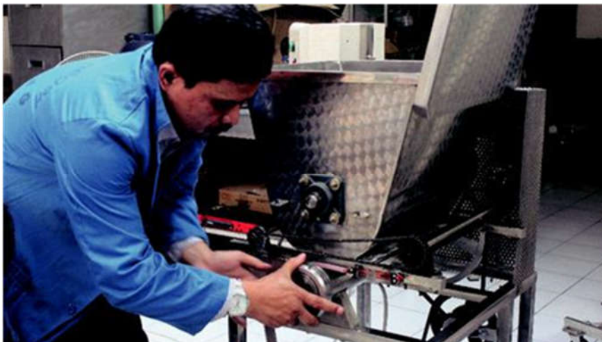
Gambar 7. Proses pemasangan extrudle
