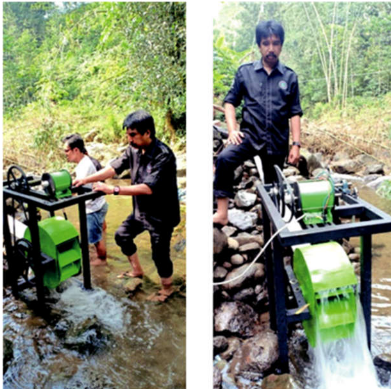
Gambar 11. Running test pembangkit listrik tenaga pikohidro
