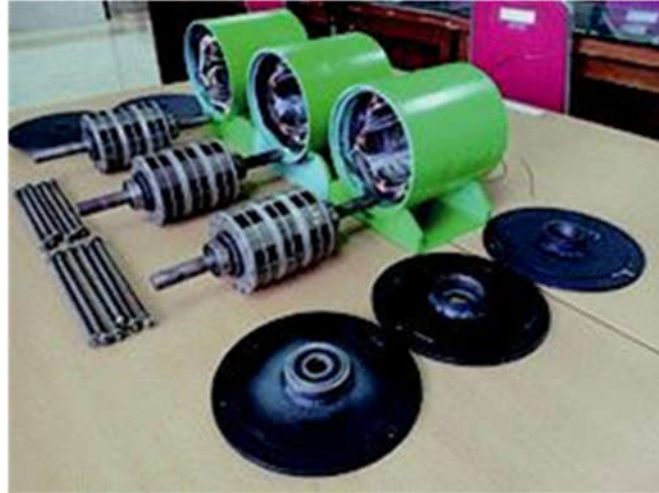
Gambar 5. Konstruksi dari rumah lilitan kumparan stator, rotor generator magnet permanen, mur-baut panjang pengikat dan tutup depan-belakang generator magnet permanen.
