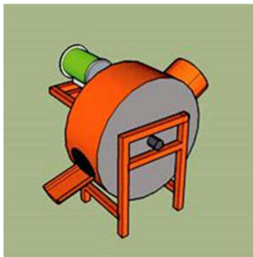
Gambar 3. Rancangan pembangkit listrik tenaga pikohidro menggunakan generator magnet permanen dilihat dari samping
