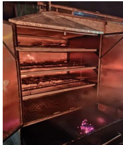
Gambar 5. Alat Lemari Pengasapan Ikan
