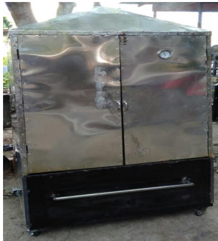
Gambar 5. Alat Lemari Pengasapan Ikan
