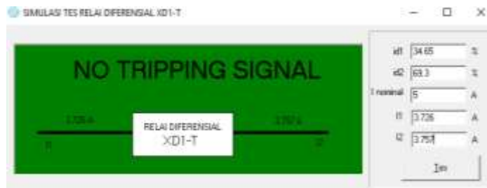
■ Gambar 17. Hasil Simulasi Trip perhitungan I_{hs} 3 fasa sebesar 4399,407 A di sisi external zone (157,5 kV)
