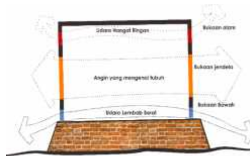
Gambar 1. Aliran Udara akibat perbedaan temperatur dalam Museum (Penulis,2019)
