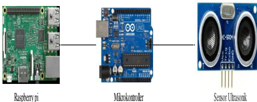
Gambar 5 Perancangan komunikasi raspberry pi, mikrokontroler, dan sensor ultrasonik
